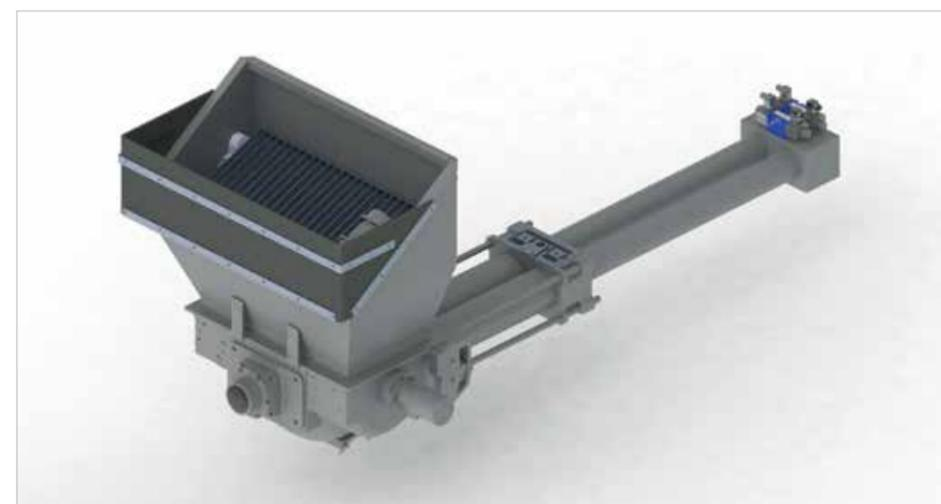
Con 80 bar di pressione massima, la PC 158 può pompare da 2 a 15 metri cubi all'ora di calcestruzzo a notevoli altezze e distanze.
